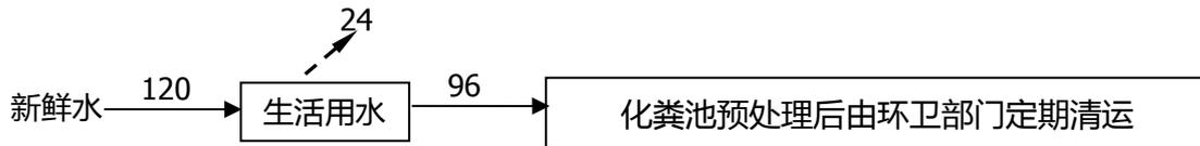
项目新鲜水用水平衡图 (  $\text{m}^3/\text{a}$  )
